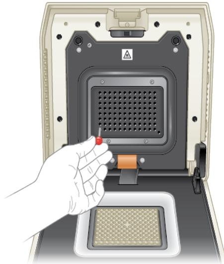
**Nota:** Occorre reinserire la vite di imballaggio nel caso in cui fosse necessario restituire il modulo di reazione per un qualche motivo. Conservare la vite in un luogo sicuro e accessibile.
