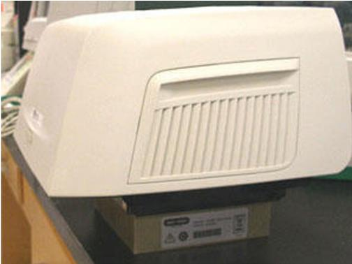
4. Con una chiave a brugola, rimuovere le due viti grandi da sotto il bordo anteriore del modulo di reazione (sotto il pulsante per l'apertura del coperchio).
